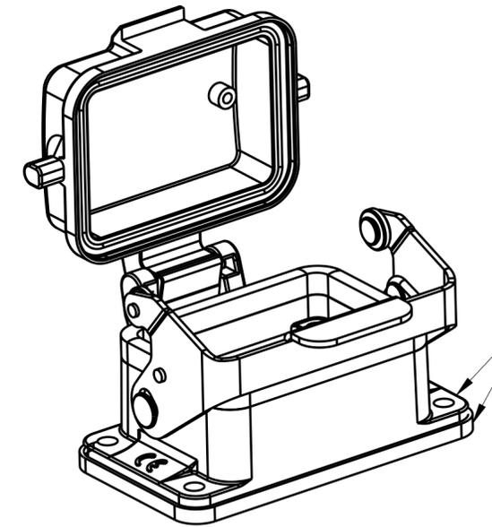
GASKET SHOULD BE FULLY GLUED WITH THE HOUSING.
